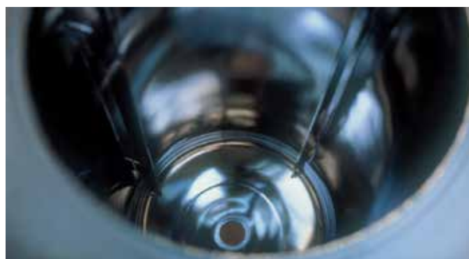
Polissage électrolytique intérieur de cuve pour l'industrie pharmaceutique
